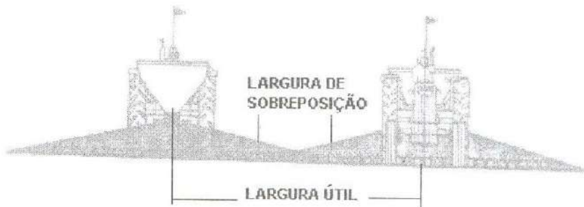
Figura 10. Largura útil da faixa de distribuição (Fonte: folheto Jan).
