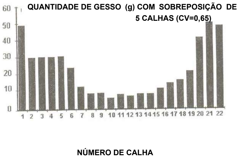
Figura 13. Faixa de deposição com 5 calhas sobrepostas.
