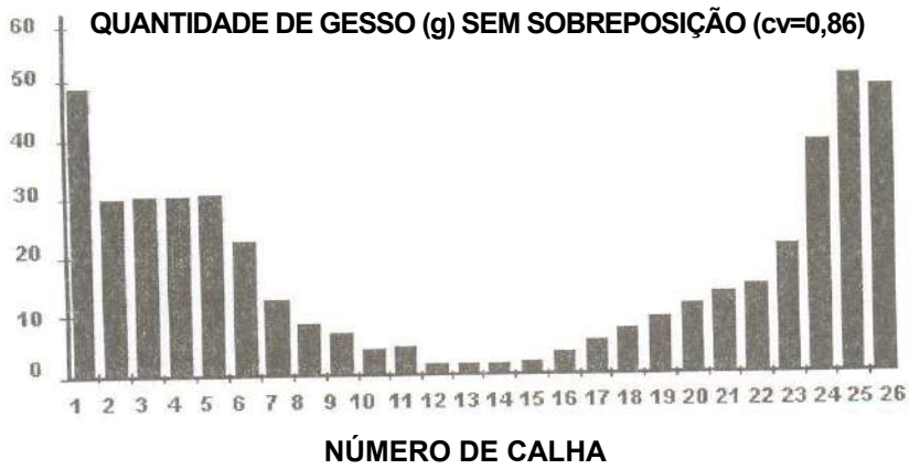
Figura 12. Faixa de deposição entre passadas, sem sobreposição.
